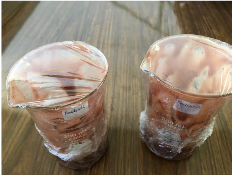
Figura 4: Emulsiones O/W 1 y 2 con \phi_{ow} igual a 0.05 y 0.1 respectivamente.
